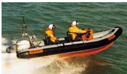
De 5.85 diepe v-boeg en sprayrails over de volle lengte. Hij kan worden voorzien van motoren tot 150 pk om mee tot het uiterste te gaan. Dankzij de superieure bestuurbaarheid is de boot in staat om zeer scherpe bochten te varen, zelfs in brekende golven.
