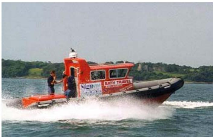
Het vlaggenschip van Ribcraft is de Ribcraft 9.0 Offshore. Deze boot is ontworpen door wijlen George Marvin die grote bekendheid genoot bij de fabrikanten van stijve rubberboten. De romp die bij de boeg zeer scherp is en naar achteren toe vlakker wordt is het antwoord op de eisen van de professionele gebruikers die op zeer ruw water varen. De Ribcraft 9.0 Offshore vervoert bemanningen met hoge snelheid over lange afstanden ongeacht de condities op zee.
