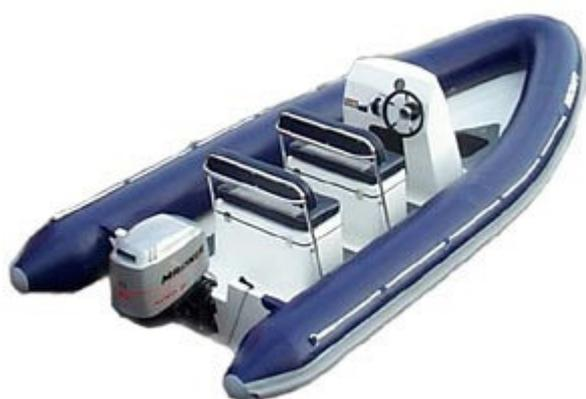
ontworpen om een grote opwaartse kracht te leveren bij lage snelheden en sneller te planeren. De Ribcraft 5.3 is het eerste model dat geheel ontworpen is met behulp van de laatste computerprogramma's. De matrijs voor de romp is door een door de computer gestuurde machine gemaakt. De eigenschappen van de romp zorgen ervoor dat de boot geschikt is voor alles, van pleziertochten en waterskien met de familie tot reddingsboot op ruwe zee.
